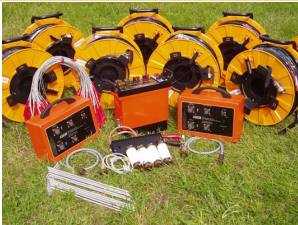
سیستم LUND با تعداد الکترودهای زیادی مورد استفاده قرار میگیرد. شکل فوق سیستم ۱۲۸ الکترودی را نشان میدهد.
